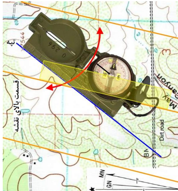
شکل ۳: رسم یک امتداد با گرای معلوم با استفاده از قطب‌نمای نظامی
