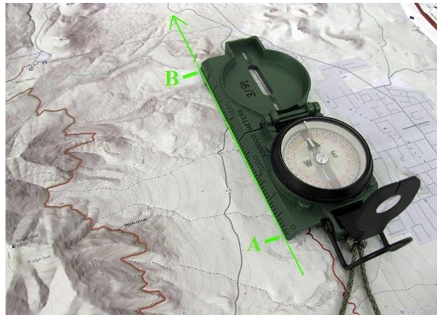
شکل ۲: اندازه‌گیری گرا بر روی نقشه با استفاده از قطب‌نمای نظامی
