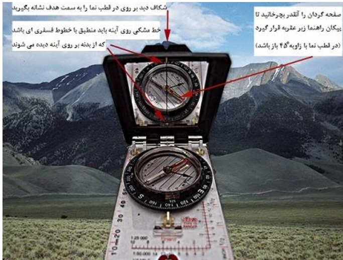
شکل ۴-۱۰: نحوه گراگیری با استفاده از قطب‌نمای شیشه‌ای
