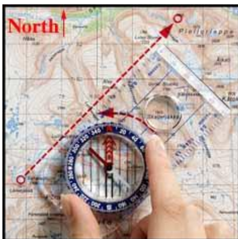
شکل ۴-۱۲: اندازه‌گیری گرا بر روی نقشه با استفاده از قطب‌نمای شیشه‌ای، در صورتی که نقشه توجیه باشد.
