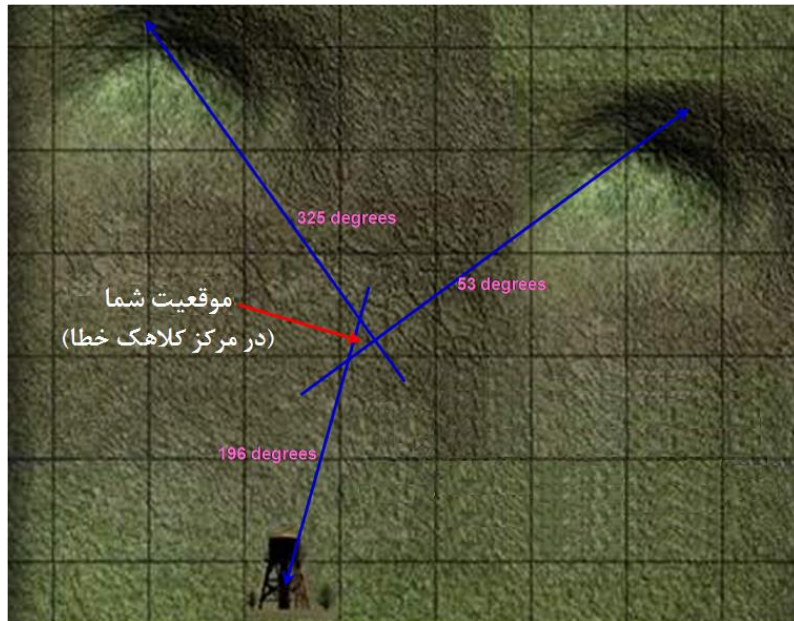
شکل ۴-۶: تعیین موقعیت بر روی نقشه به روش تلافی سه گرا
