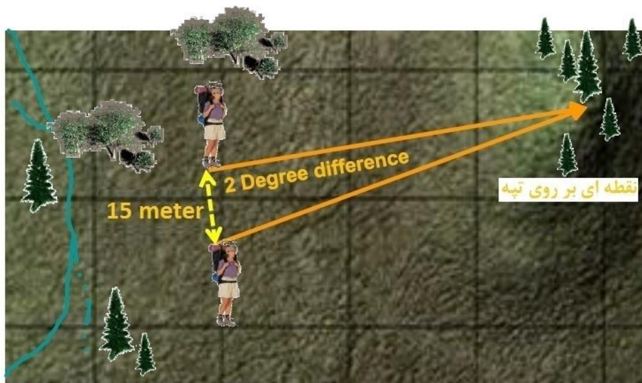
شکل ۱۲: تخمین مسافت با استفاده از ارقام درجه قطب‌نما (روش دوم)
