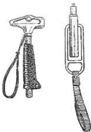
تصویر ۷۷. چکش غارنوردی از فولاد ضد زنگ (چپ) و دسته رول سبک و کوچک
