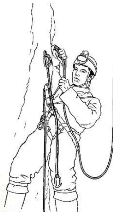
تصویر ۲۷۵. به هنگام نصب لوپ ریلی، زیر ابزار فرود، یک گره استاپر بزنید.
