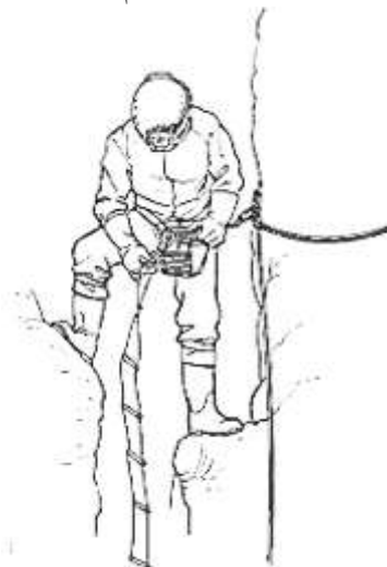
تصویر ۷۶ - حلقه کردن نردبان کابلی
