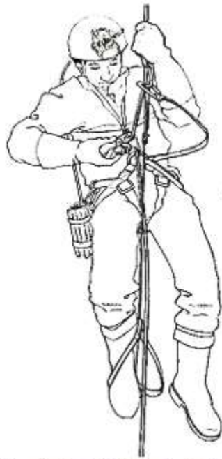
تصویر ۱۷۱. فرود روی ابزار صعود، به پایین حرکت دادن ضامن اجازه می دهد که طناب در ابزار صعود بلغزد.
