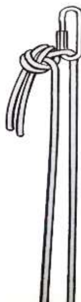
تصویر ۶۴. گره سردست جهت پایین کشی طناب
