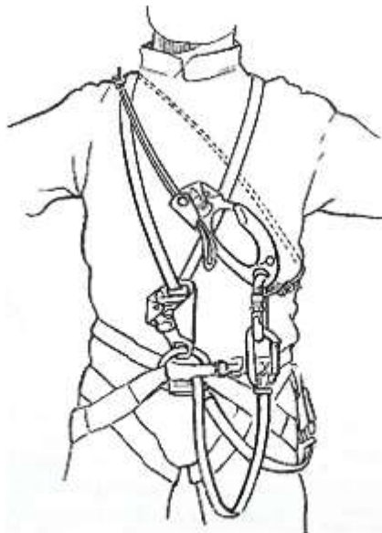
تصویر ۳۱. چگونگی پوشیدن ابزار در سیستم فراگ (Frog) به‌هنگام پیمایش بین چاه‌ها
