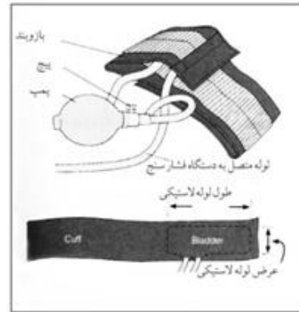
تصویر ۳-۴. قسمت‌های مختلف دستگاه فشارسنج
